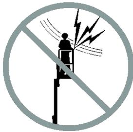
Mantenha-se afastado da máquina se ela entrar em contato com linhas de alimentação energizadas ou se ela se tornar eletricamente carregada. As pessoas que estiverem no solo ou na plataforma não devem tocar nem operar a máquina até que as linhas de alimentação energizadas sejam desligadas.
