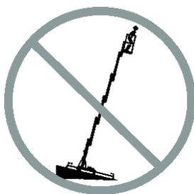
Não eleve a plataforma a não ser que a máquina esteja nivelada. Não coloque a máquina sobre uma superfície onde ela não possa ser nivelada usando apenas os niveladores.
