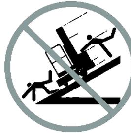
Use bom senso e planejamento para controlar o movimento da máquina em superfícies inclinadas ou próximo a elas.
