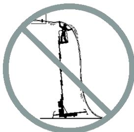
Não exerça forças horizontais nem crie cargas laterais na máquina, elevando ou abaixando cargas fixas ou suspensas.
