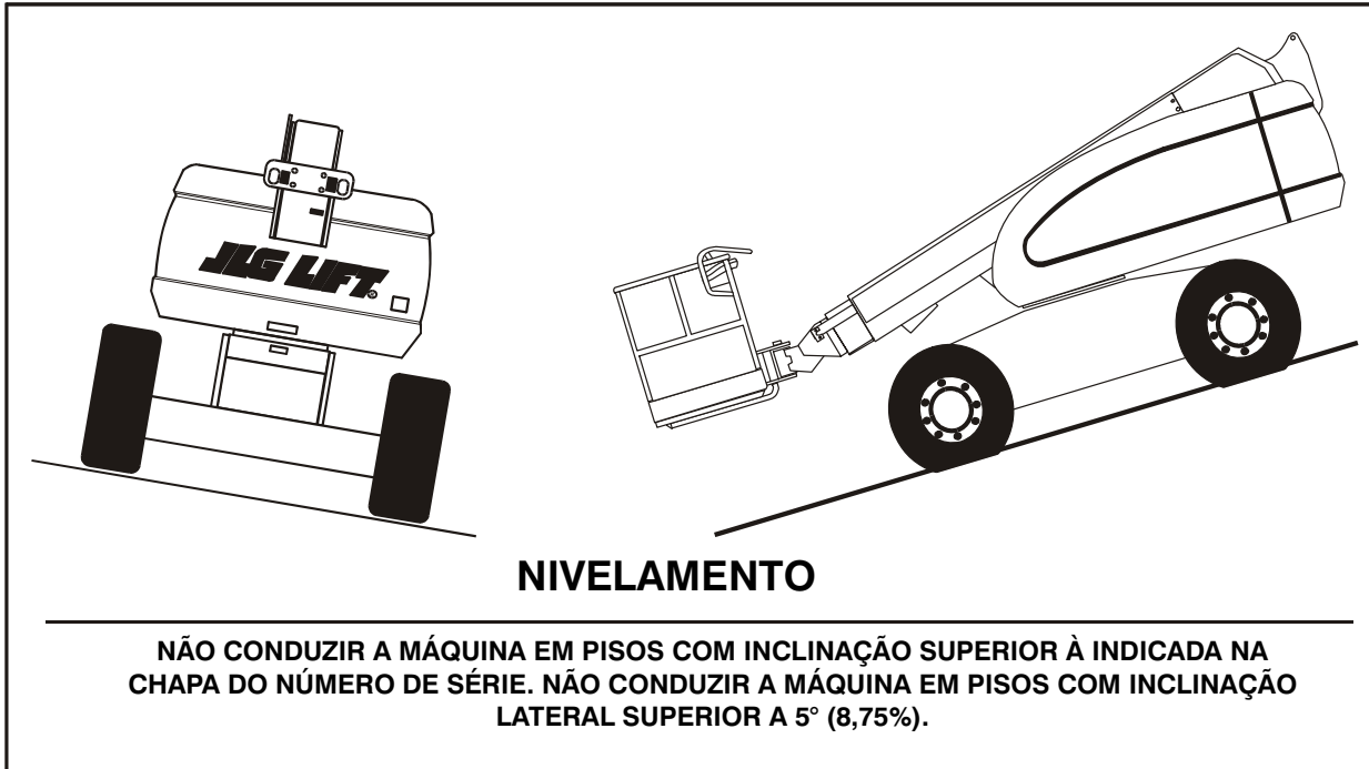
Figura 4-3. Inclinação longitudinal e lateral
